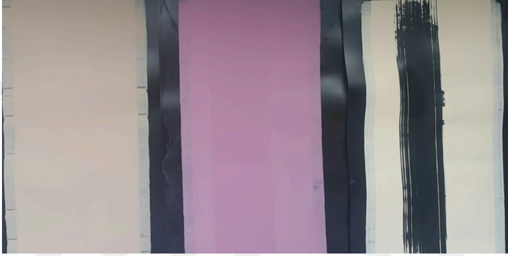
Şekil 6.2. Bağlayıcı miktarına göre scrub (aşınma) testi sonucu.
