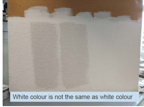
Şekil 6.11. Tek Kat Boya Yüzeye Uygulama Sonrasındaki Beyazlık Viskozite Karşılaştırması.
