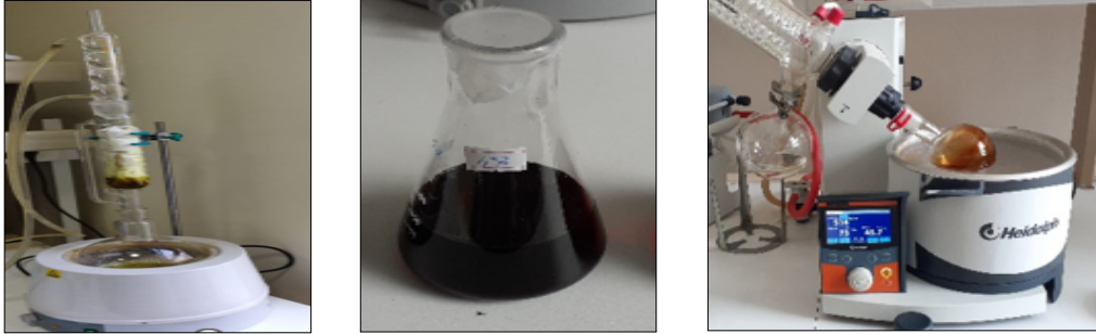
Resim 3.2. Ekstraksiyon sonrası elde edilen G. glabra örneğinin etanol özütü ve evaporatör ile uzaklaştırma işlemi
