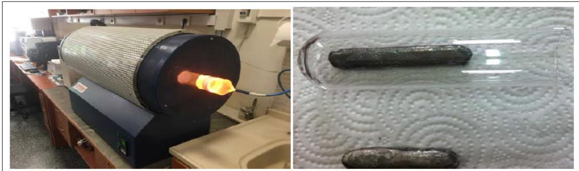
Resim 4.5. Homojenleştirme işleminde kullanılan spektroskopik azot gazı atmosferine alınmış tüp fırın ve quartz tüp içerisine yerleştirilmiş ingot halindeki alaşımlar
