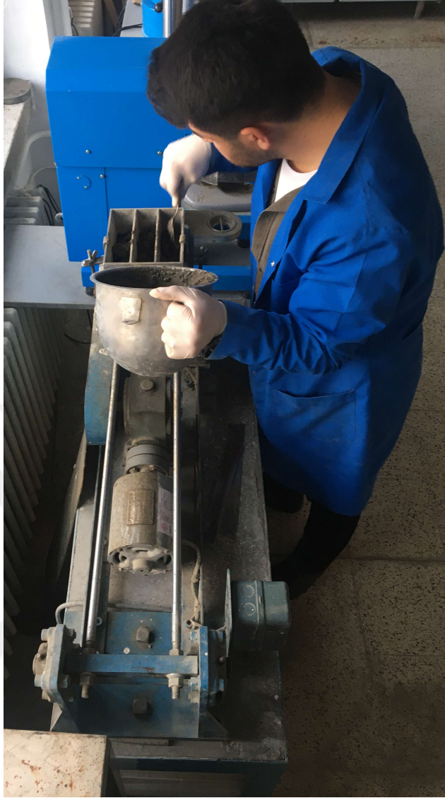
Şekil 3.6. Karışımın kalıplara yerleştirilmesi
