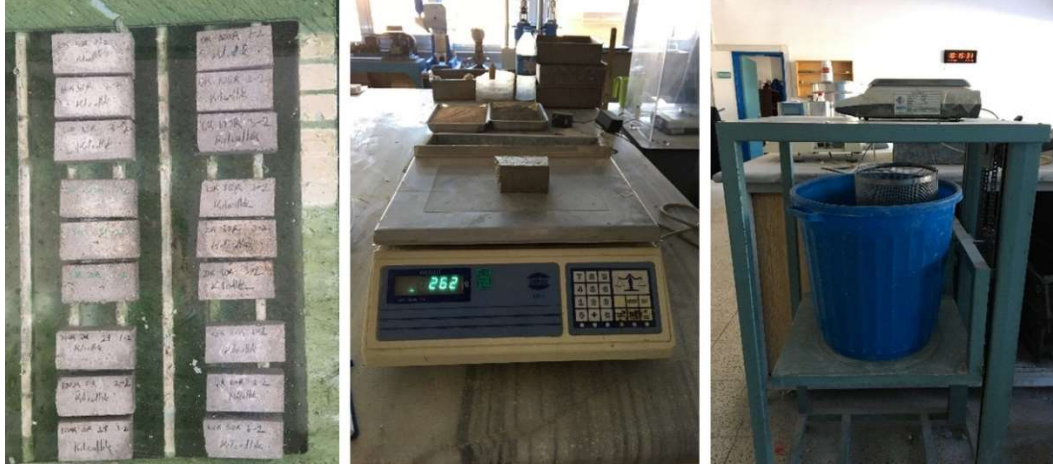
Şekil 3.11. Birim ağırlık ve su emme deneyine ait görseller
