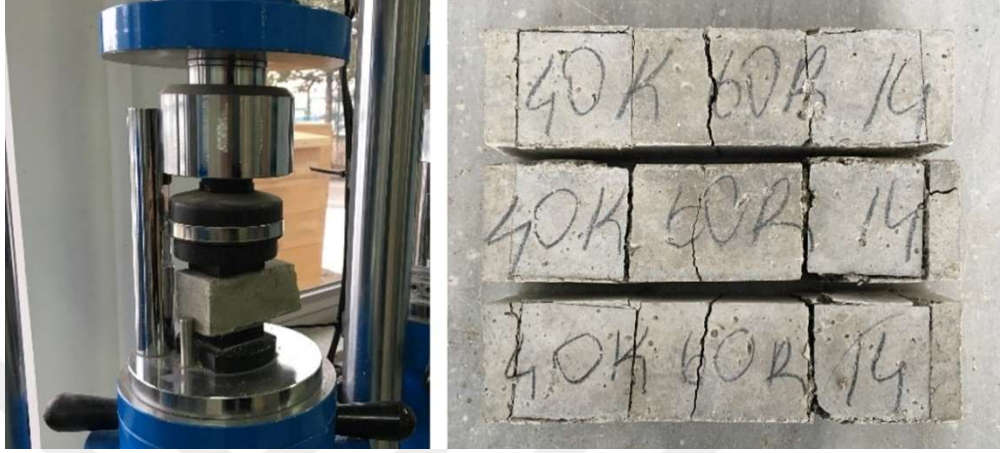
Şekil 3.10. Basınç dayanımı test düzeneği ve 40K60R setine ait deney sonrası görsel
