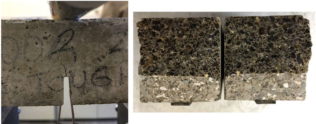
Şekil 3.17. Numunede çatlak gelişimi ve kırılmadan sonraki en kesit görüntüsü
