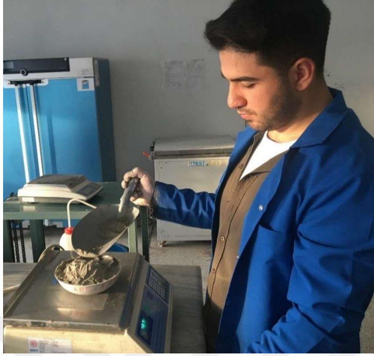
Şekil 3.1. Portland çimentosunun tartılması
