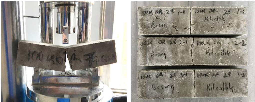
Şekil 3.9. Eğilme dayanımı test düzeneği ve 100K0R setine ait deney sonrası görsel
