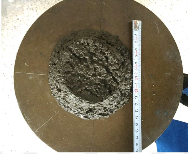
Şekil 3.8. Yayılma miktarının ölçülmesi
