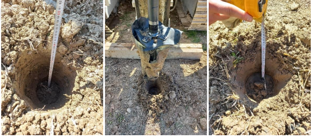
Görsel 4.5. Araziye açılan deneme kuyuları, a-b. Kumlu zemin, c-d. Gevşetilmiş killi zemin ve e-f. Doğal killi zemin
