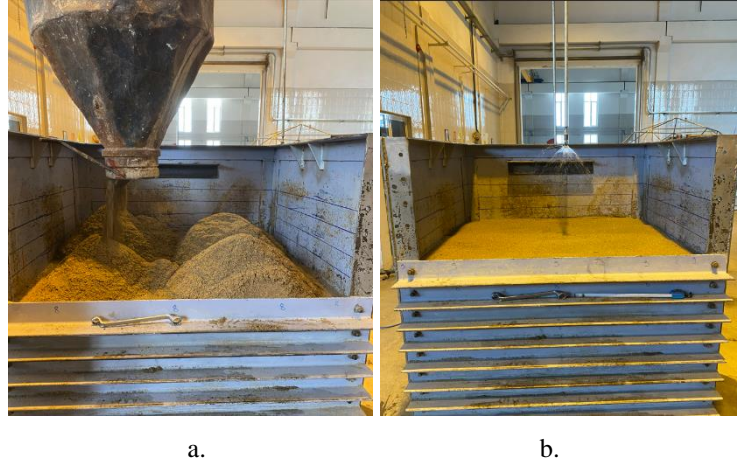
Görsel 3.22. a. Hücre içerisine zeminin kuru yağmurlama tekniğiyle yerleştirilmesi ve b. Su ile yağmurlama
