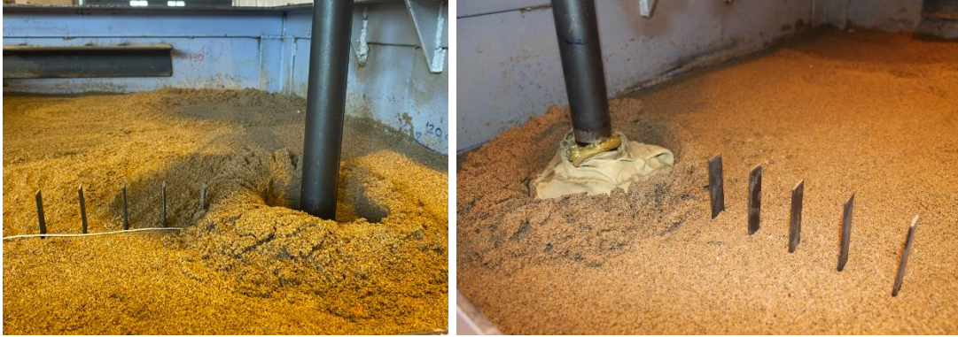
Görsel 3.26. Tokmaktama probu etki yarıçapının tespiti
