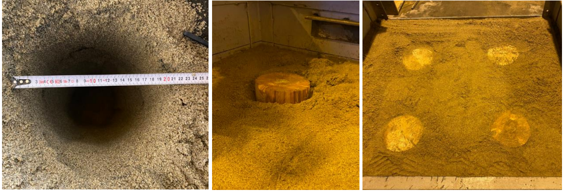
Görsel 3.26. (Devam) a-b. Yanal tokmaktama süreci, c-d. İyileştirme sonrası açılan kuyu ve e-f. Ahşap kütüklerin yerleştirilmesi
