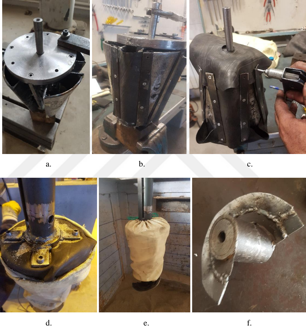
Görsel 3.17. a. Probuun metal iskeleti, b-c. Kanat araları ve disklere şambrel montajı, d-e. Aramid kumaş montajı ve f. Helezonlu delici uç
