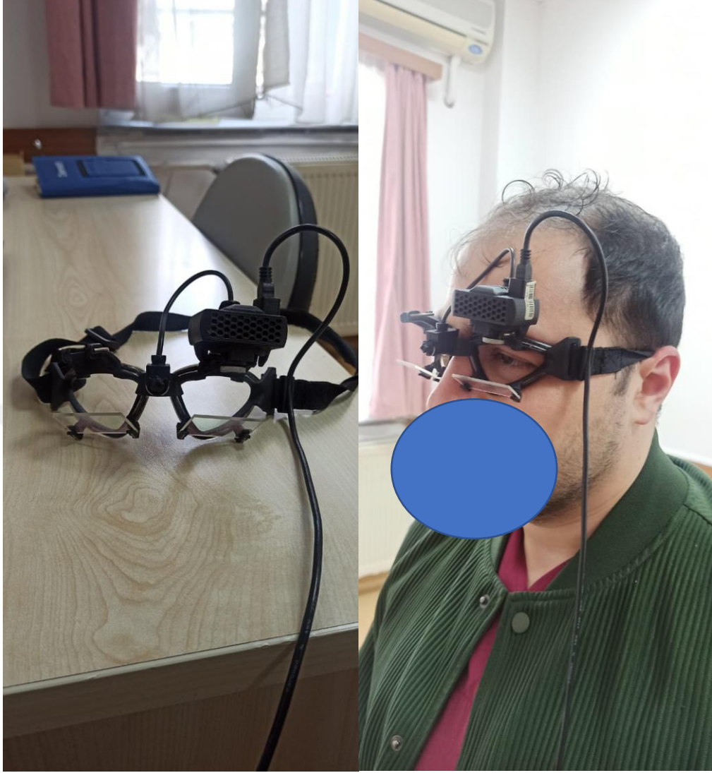
Resim 3.6. Göz hareketlerinin, üzerine kamera sistemi monte edilmiş gözlük yardımıyla yüksek kaliteli bir uzaktan kamera ile kayıt edilmesi.
