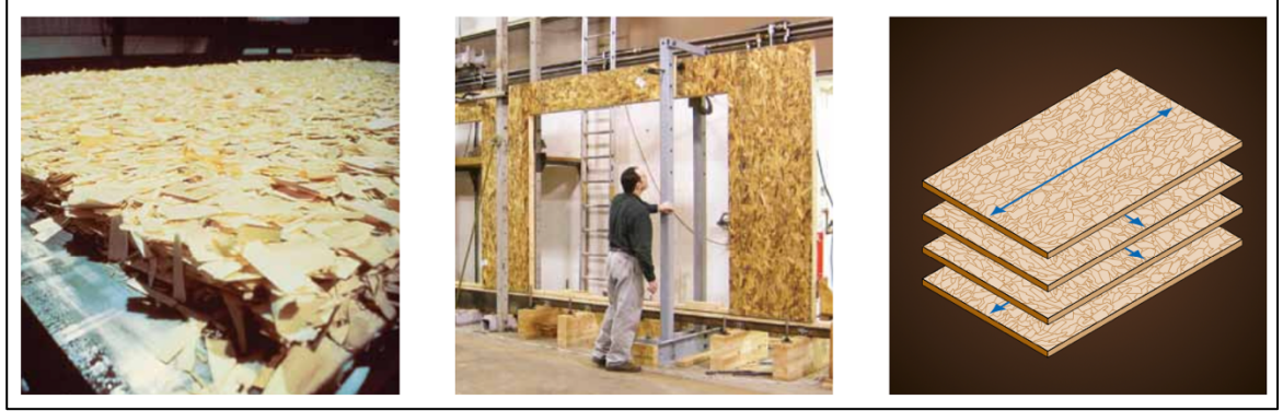
Şekil 4. 1. İnce dikdörtgen biçimli ahşap şeritlerden üretilen OSB (APA 2010)
