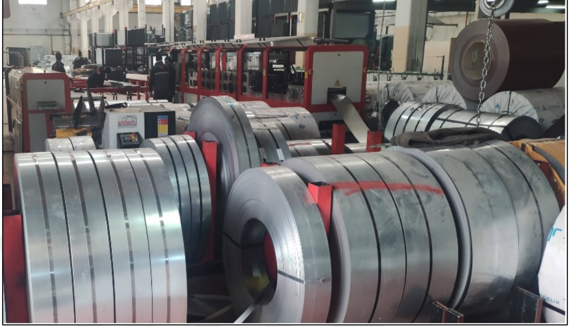
Şekil 3. 11. Galvaniz çelik rulo sac dilmeleri, İstanbul (Orijinal 2020)
