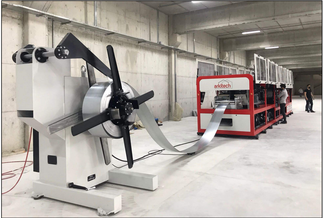
Şekil 3. 12. Hafif çelik soğuk büküm profil makinesi, Yozgat (Orijinal 2021)
