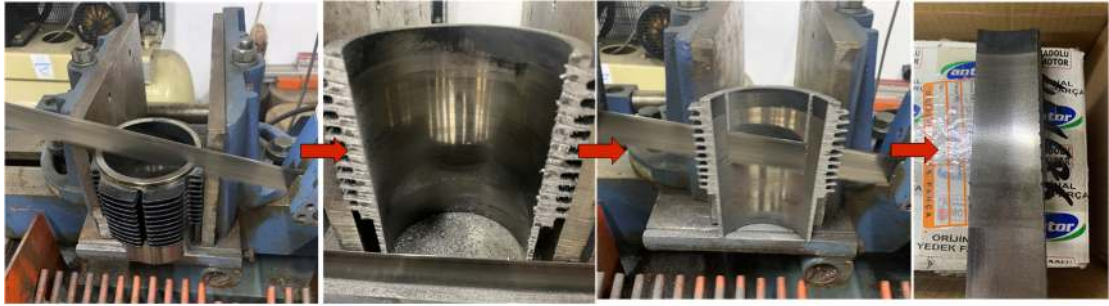
Şekil 4.10 Motor testleri sonunda silindir kovanlarının kesilmesi
