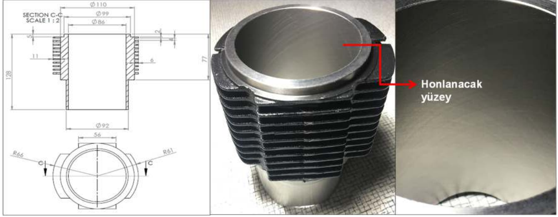
Şekil 2.5 Antor LD 400 motorunun farklı açılarda honlanacak yüzeyi
