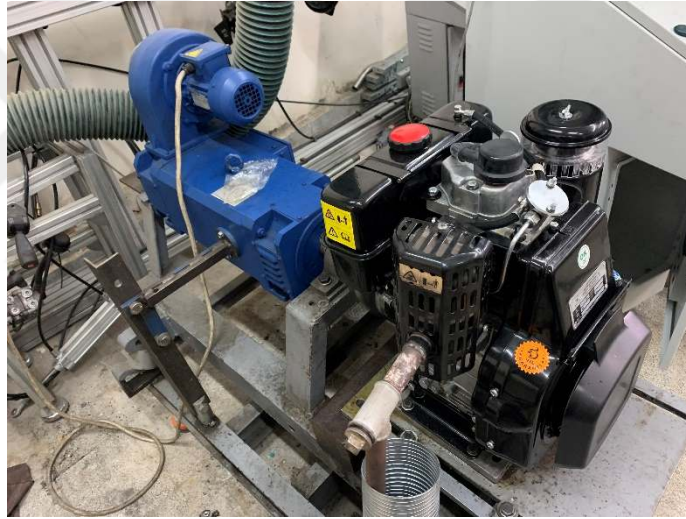
Şekil 2.26 Motor dinamometre testi
