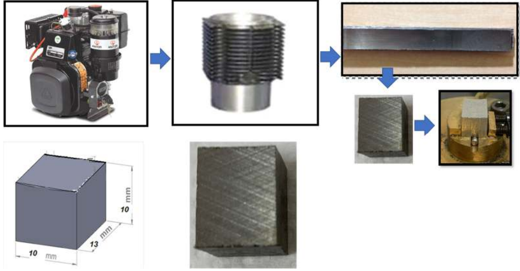
Şekil 2.7 Silindir numunelerinin kesilmesi
