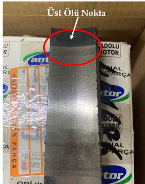
Şekil 4.10 Motor testleri sonunda silindir kovanlarının kesilmesi
