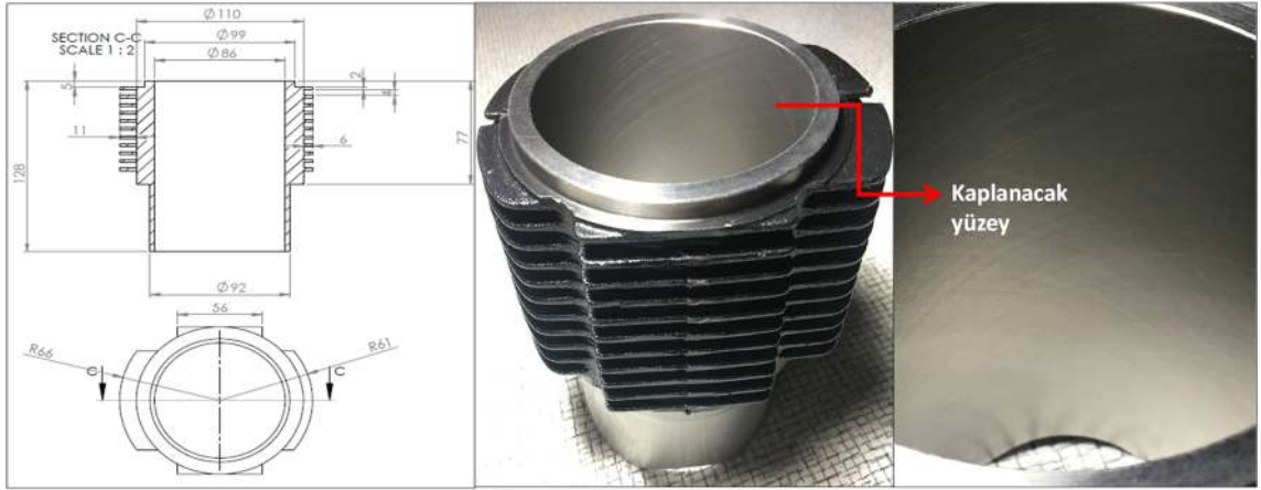
Şekil 2.6 Antor LD 400 motorunun farklı açılarda nanokaplanacak yüzeyi
