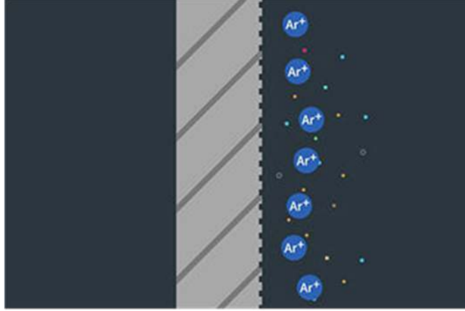
Şekil 2.19 Dağlama (sıçratma) işlemi
