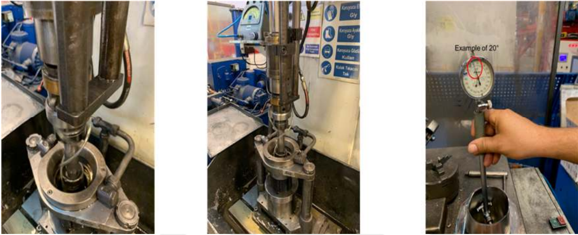
Şekil 2.13 Ham kovanın honlama işlemleri
