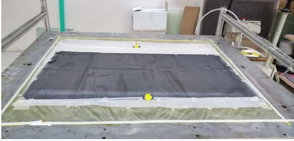
Şekil 2.12 Peel ply malzemesi ve epoksi filesinin sisteme yerleştirilmesi (Kişisel arşiv, 2023)
