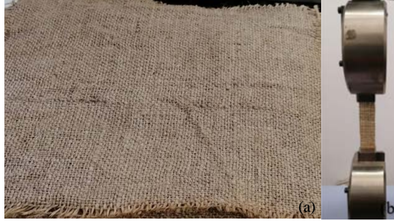
Şekil 2.4 Jüt kumaş (a) ve jüt kumaş çekme deneyi (b) (Kişisel arşiv, 2023)
