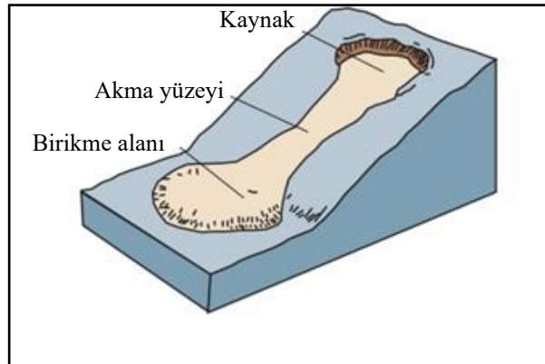
Şekil 1.12. Toprak akması şematik gösterimi (USGS, 2004)
