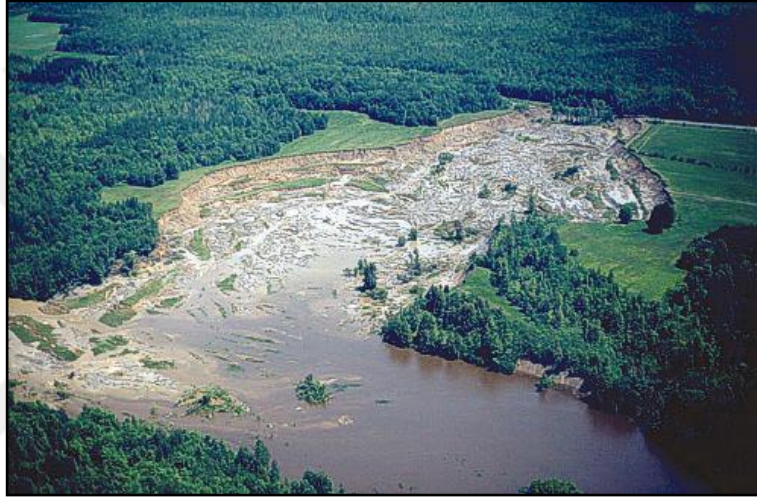
Şekil 1.11. 1993 Lemieux heyelanı-Kanada, Ottawa yakınlarındaki hassas deniz kilinde hızlı bir toprak akması (USGS, 2008)
