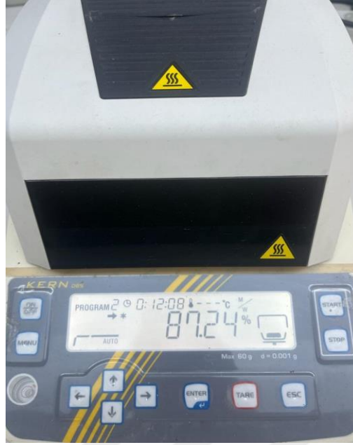
Şekil 3.10. Hızlı nem tayin cihazında örneğin nem içeriğinin belirlenmesi
