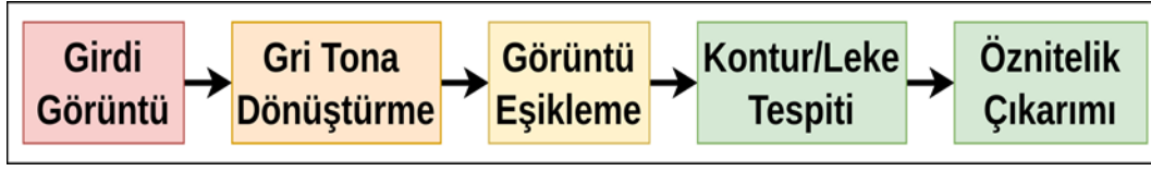
Şekil 3.1. Öznitelik çıkarma sisteminin akış şeması
