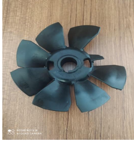
Şekil 4.21: Pervanesi Kırılan Fan.
