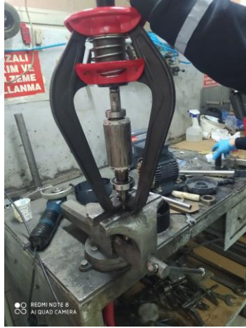
Şekil 5.1: Arızalı Rulmanların Değişimi.
