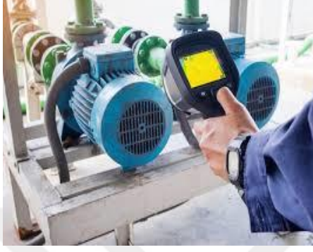
Şekil 1.11: Termal İzleme ile Kestirimci Bakım Uygulaması (Voltimum, 2020).
