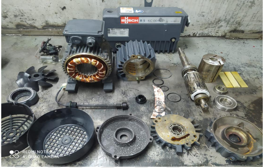
Şekil 4.4: Bakımı Yapılan R5 RC 0040 Vakum Pompası Demontaj İşlemi.
