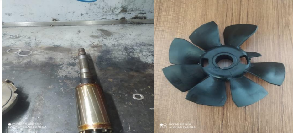
Şekil 5.2: Kırık Fan ve Yüke Binmiş Rotor Deformasyonu.
