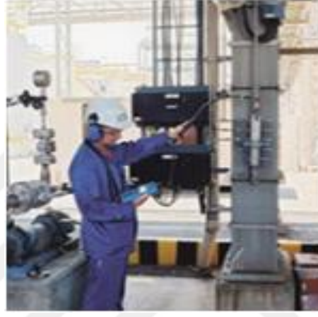
Şekil 1.14: Ultrason ile Kaçak Testi.
