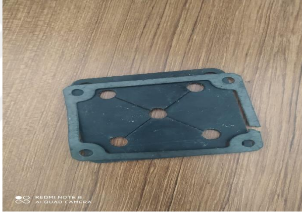
Şekil 4.22: Conta ve Sızdırmazlık Elamanlarının Deforme Olması.
