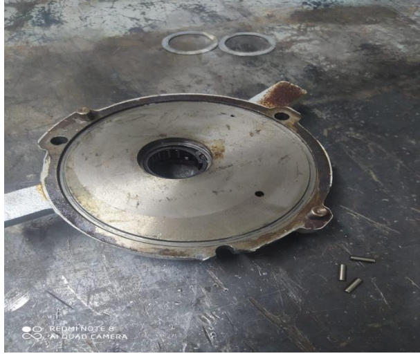
Şekil 4.16: Rulmanı Dağılan Vakum Pompası
