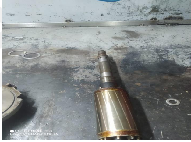
Şekil 4.17: Balansı Bozulan Motor Mili Ekseni Kaçması
