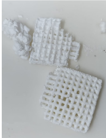
Şekil 3.1 Boyutlu Yazıcı Kullanılarak Üretilen Saf Biyoaktif Cam Doku İskelesi
