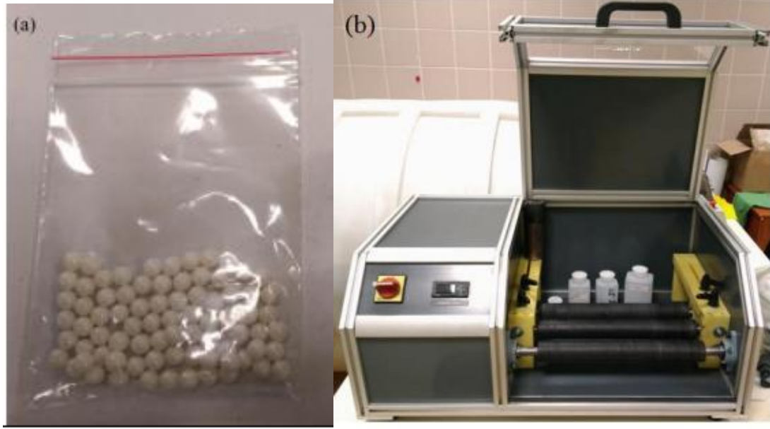
Şekil 3.1. (a) Zirkonyum bilye (b) MSE-TEC marka bilyeli değirmen
