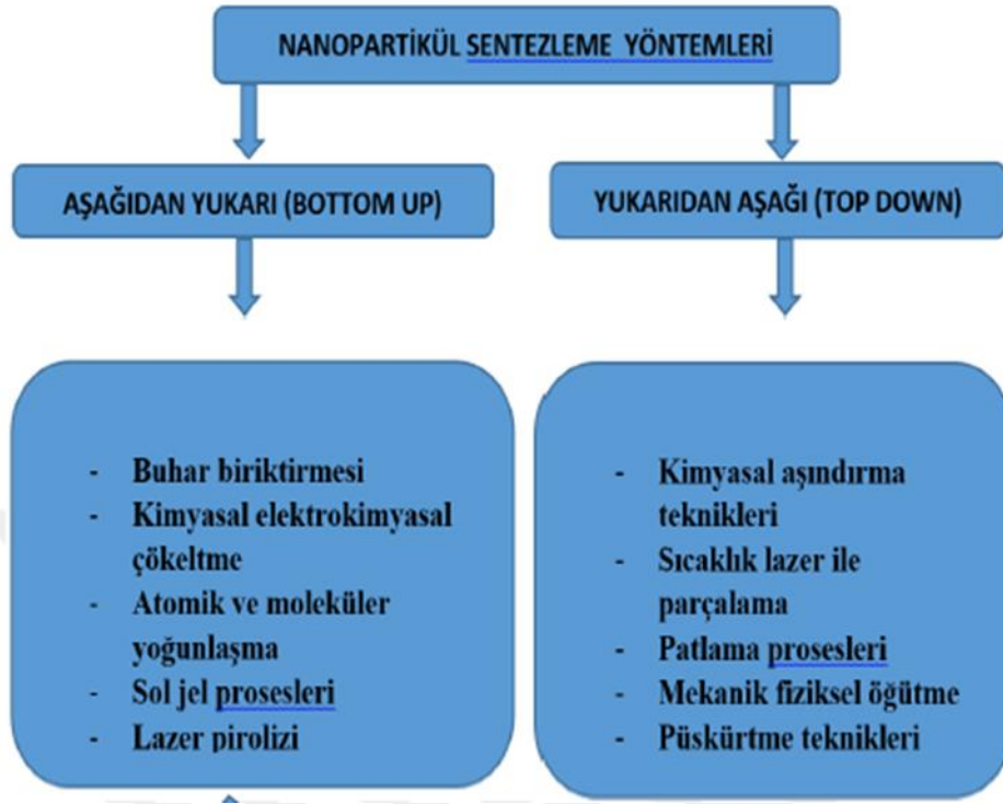
Şekil 2.10. Nanokompozit sentezleme yöntemleri (Rajoriya, 2017)
