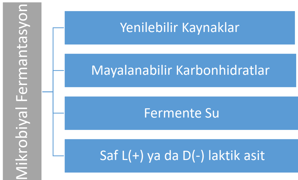
Şekil 11. Laktik asitin kimyasal sentez ve mikrobiyal fermantasyonu (Komesu ve diğ, 2017)
