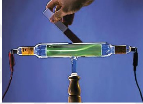
Şekil 6. Thomson katot ışınları deneyi (Bilenler, 2016, s.10)
