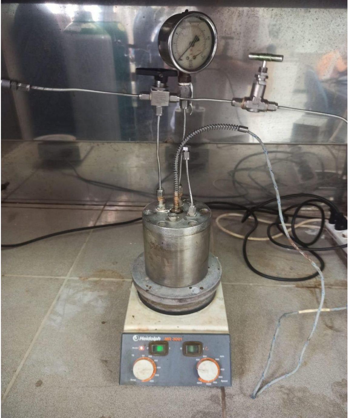
Şekil 9. SKS Yöntemi ile Badem Kabuğu Hidrokömürü Eldesi
