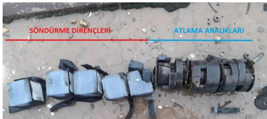
Şekil 3.8. Hasarlanan C faz parafudr içi (Doğanay, 2022).
