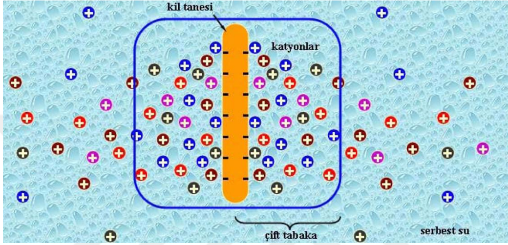
Şekil 2-7. Kil- Su Sistemi (Sivakugan, 2001).
