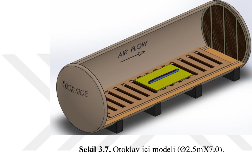
Şekil 3.7. Otoklav içi modeli (Ø2,5mX7,0).
