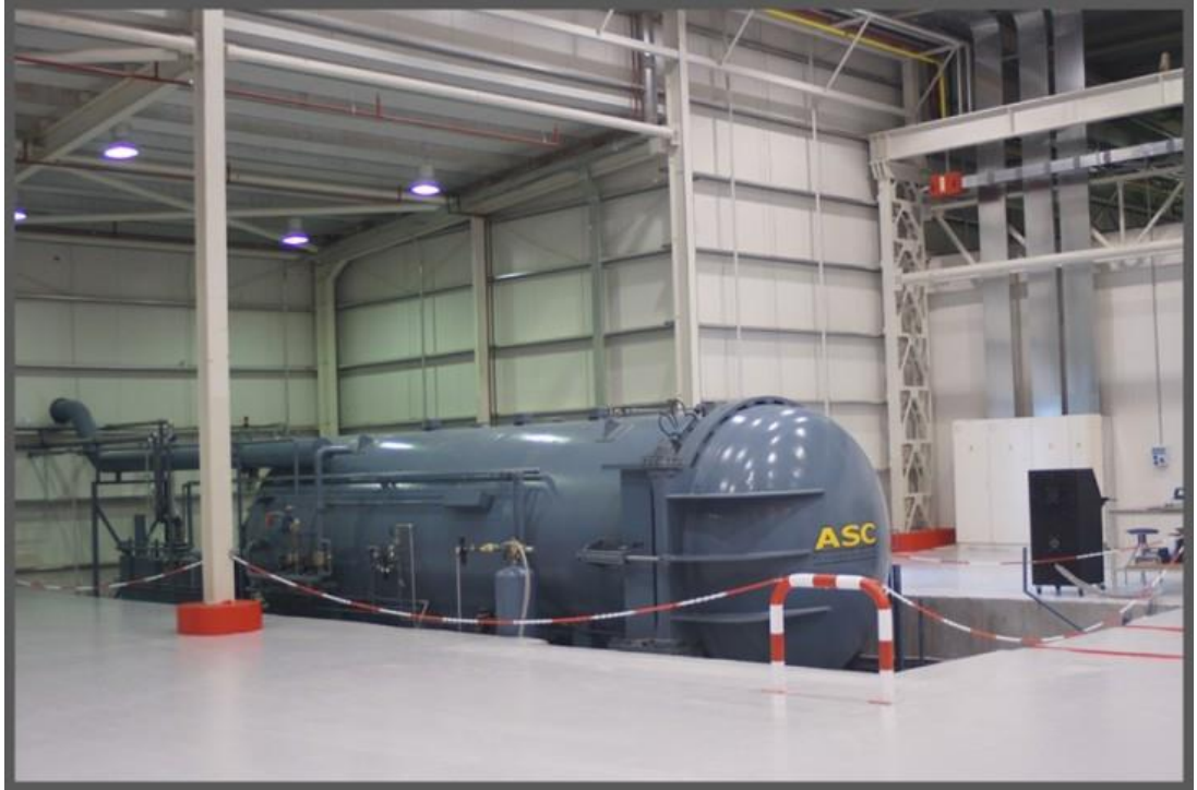
Şekil 3.8. Otoklav sistemi (Ø2.5mX7.0m - ASC) [19].
