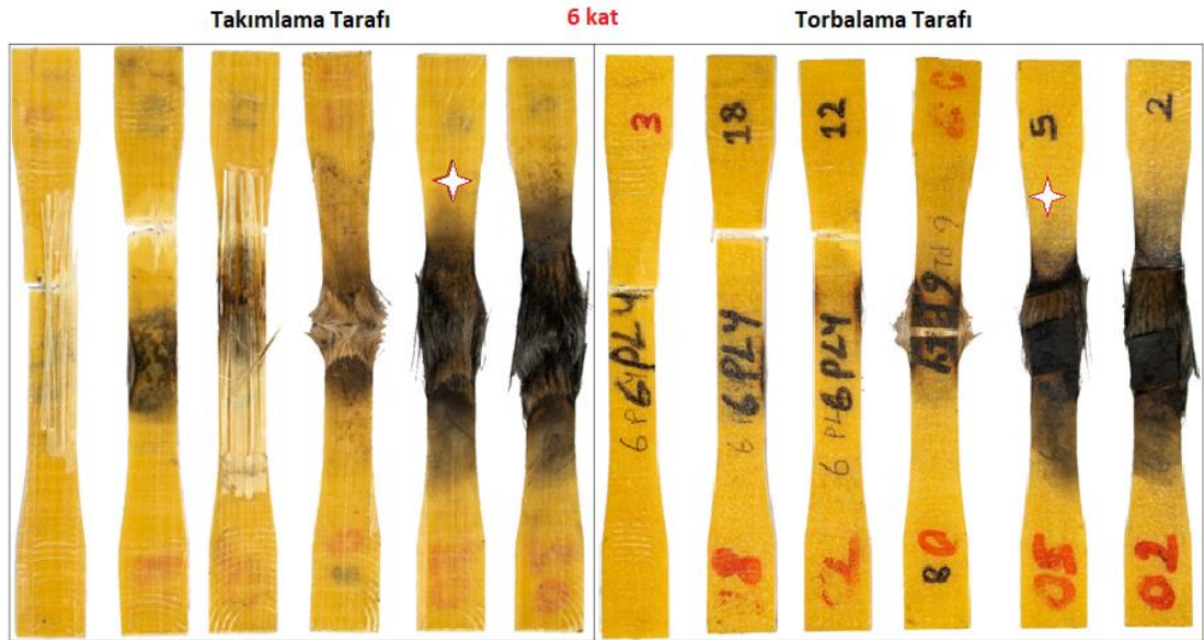
Şekil 3.46. Çekme deneyi sonrası, 6 kat numunelerin genel görünüşü.
