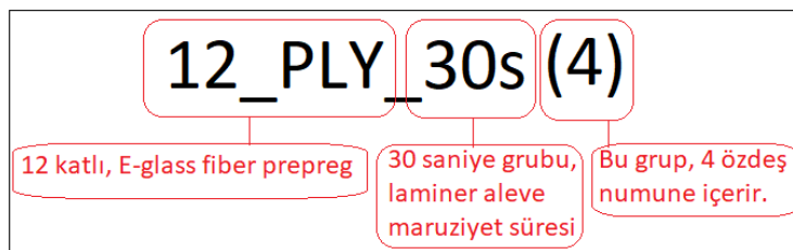
Şekil 3.24. Yangın deneyi kodlamalarının anlamları.
