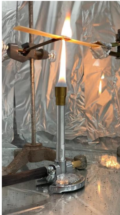
Şekil 3.25. Yangın deneyinden bir kesit, malzemenin kendi kendine tutuşması.
