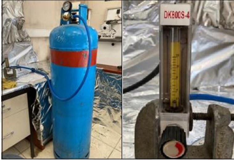
Şekil 3.18. Saf propan tp, 45 dm 3 ve Debiöler (16 L/h) ve basın kontrol valfi.
