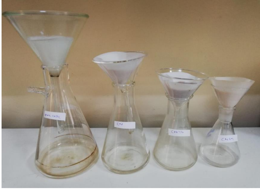
Şekil 3.4. Numunelerin santrifüjleme işlemi sonrası süzülmesi.
