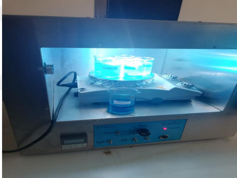
Şekil 3.8. Ultraviyole ışınımı altında foto-reaktörde numunelerin gösterimleri
