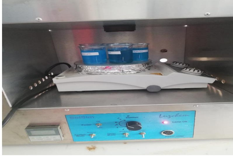
Şekil 3.7. Ultraviyole ışınım cihazının altında, ışık verilmeden önce foto-reaktörde numunelerin gösterimleri
