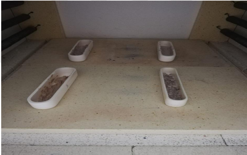
Şekil 3.5. Kurutmadan sonra krozelerde 600 °C 180 dk ısıl işlem
