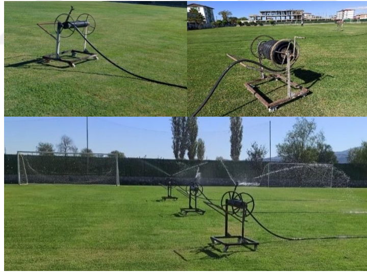
Şekil 4.6. Iğdır belediyesi semt sahası portatif sprink yağmurlama sulama sistemi
