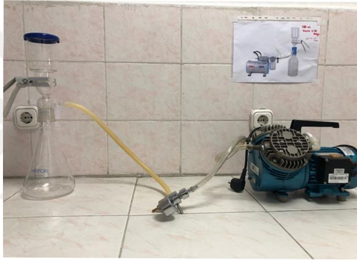
Şekil 3. 2 Membran filtrasyon sistemi
