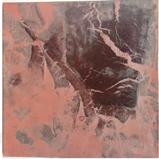
Şekil 43: Deneme 25, 2023, 20x20 cm, Kalıp içi sırlama, kırmızı çamur, 1165 °C (Fotoğraf: Rıdvan Yayman)
