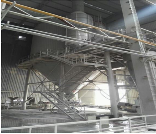
Şekil 2: Püskürtmeli kurutucu ve kurutucudan çıkan granül Graniser Seramik Fabrikası (Gün, 2019)
