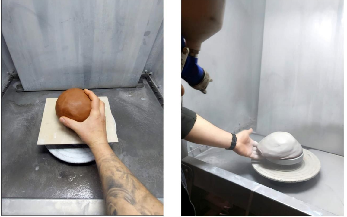
Şekil 12: Yoğurulup şekil verilmiş yaş çamurlara ilk kat astar uygulaması. (Fotoğraf: Şeyma Yayman)
