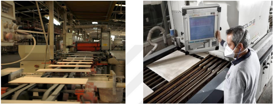
Şekil 6: Graniser Seramik Fabrikası sırlama bantları ve inkjet baskı bölümü
