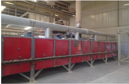
Şekil 4: Seramik kurutma işleminde kullanılan dikey ve yatay kurutucular.
