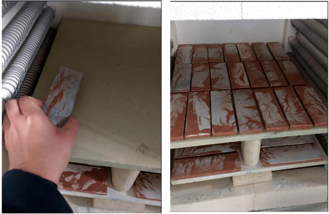
Şekil 18: Sırlı tek pişirim için fırına yerleştirilen karolar ve pişirim süreci.
