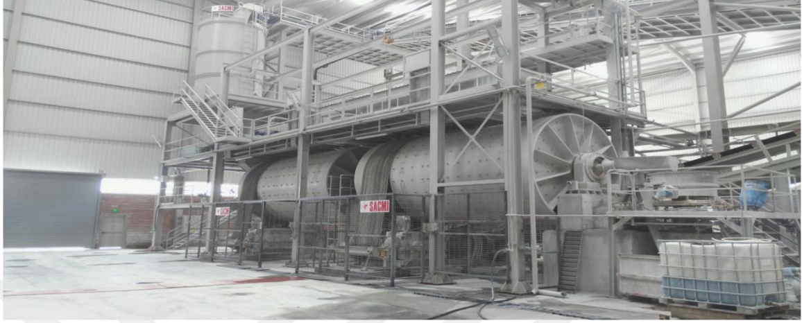
Şekil 1: (Graniser Seramik Fabrikası'nda hammadde öğütmek için kullanılan bilyeli değirmen) (Gün, 2019 : 6)
