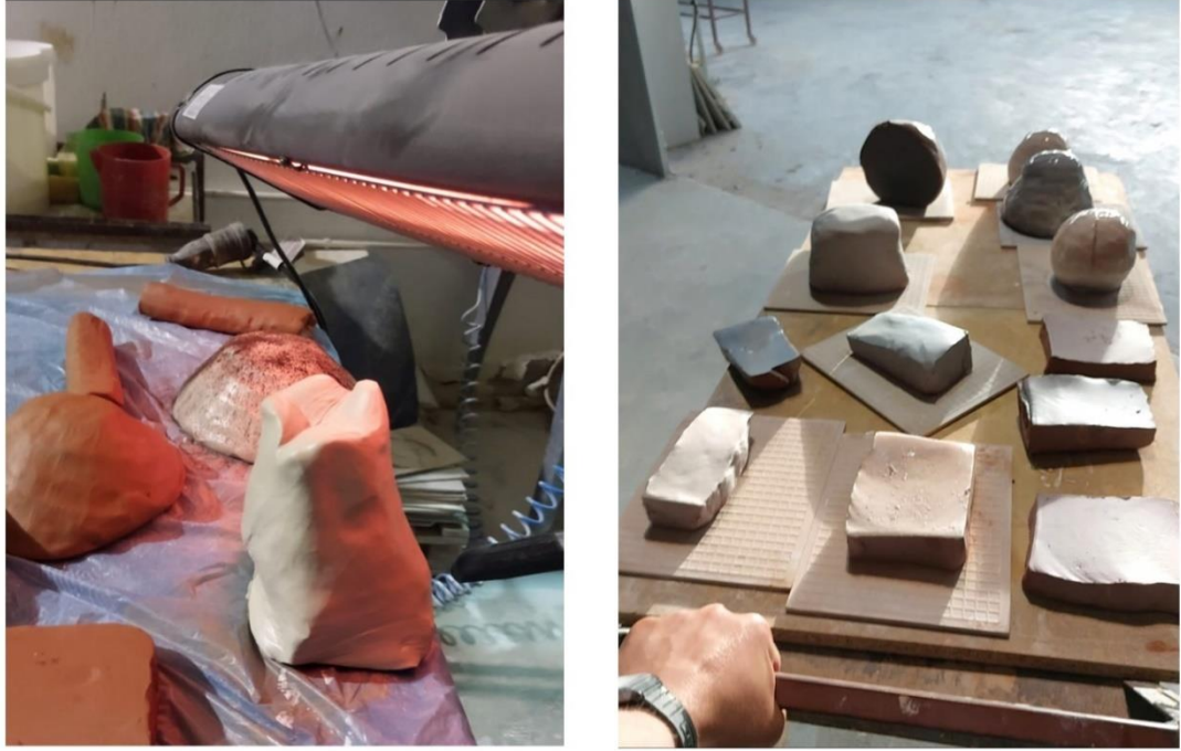
Şekil 14: Çamurların sır ve astar katmanlarının elektrikli ısıtıcı ile kurutulması ve pres basımına giden halleri (Fotoğraf: Şeyma Yayman)
