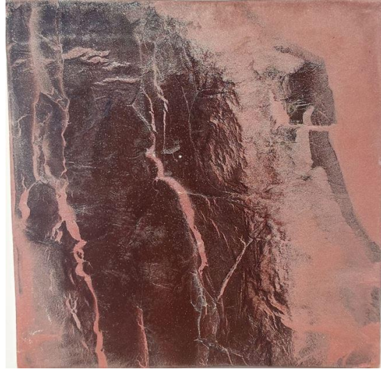
Şekil 44: Deneme 26, 2023, 20x20 cm, Kalıp içi sırlama, kırmızı çamur, 1165 °C (Fotoğraf: Rıdvan Yayman)
