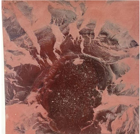
Şekil 34: Deneme 16, 2023, 20x20 cm, Kalıp içi sırlama, kırmızı çamur, 1165 °C (Fotoğraf: Rıdvan Yayman)
