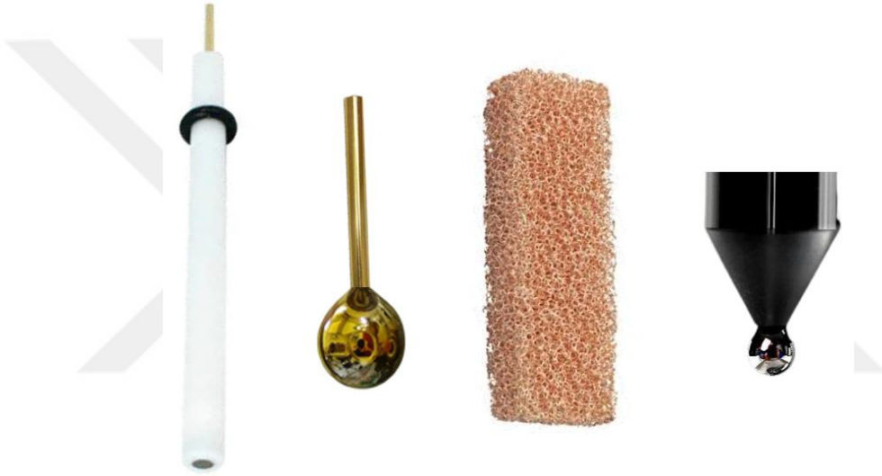
Şekil 40. Camsı karbon, altın, bakır köpük ve civa damlası çalışma elektrotlarının fotoğrafları.
