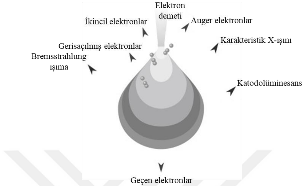
Şekil 50. Hızlandırılmış elektron demetinin katı numune yüzeyi ile etkileşimi sonucunda oluşabilecek ışınım ve elektron türleri (Kempen 2021).
