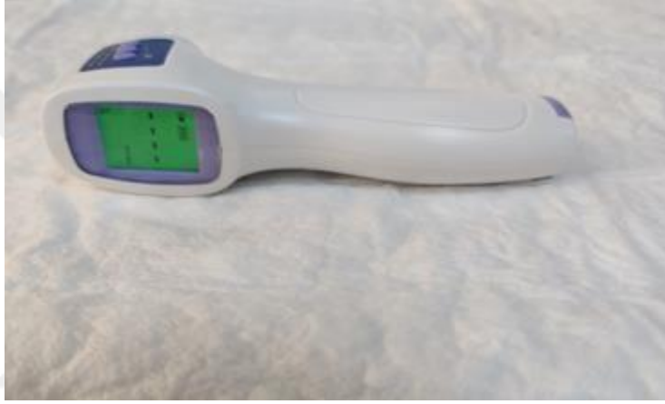
Resim 5. Kızılötesi Temassız Dijital Termometre
