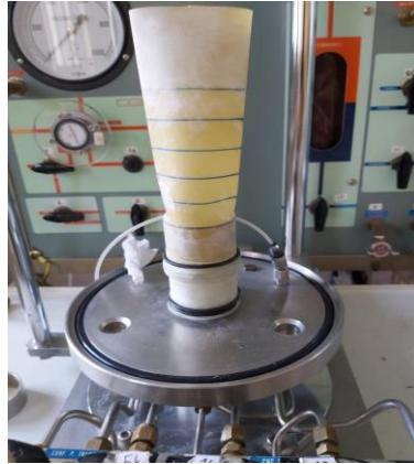
Şekil 4.10 Eski membranlar ve O-halkalar kullanarak sızdırmazlığın artırılması.
