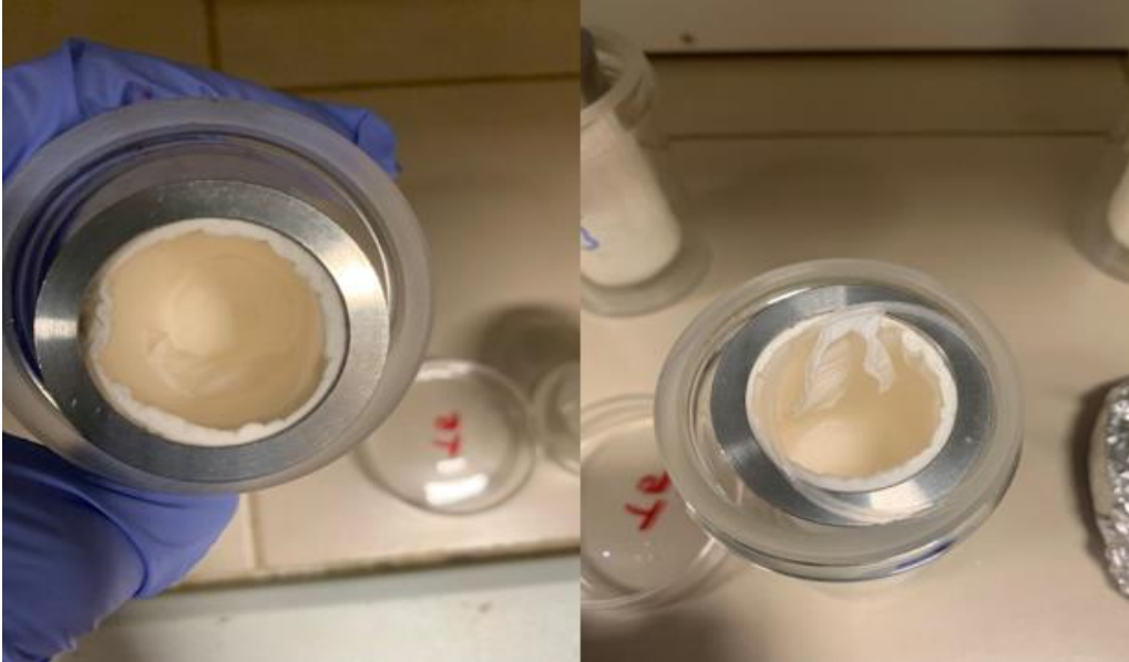
Şekil 4. 11. Filtrelerin solvent ekstraktör kartuşlarına yerleştirilmesi
