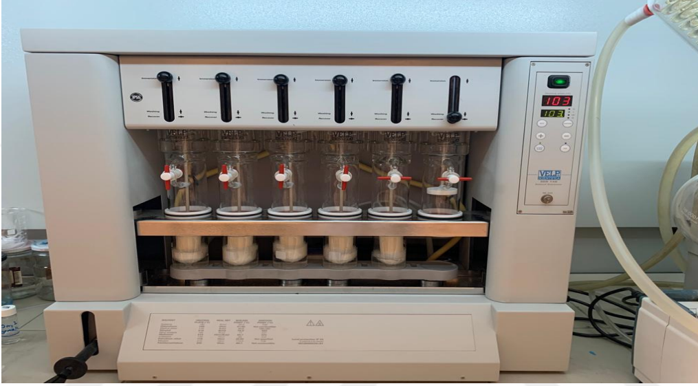
Şekil 4. 10. Kapalı solvent ekstraktör cihazında gerçekleştirilen ekstraksiyon işlemi
