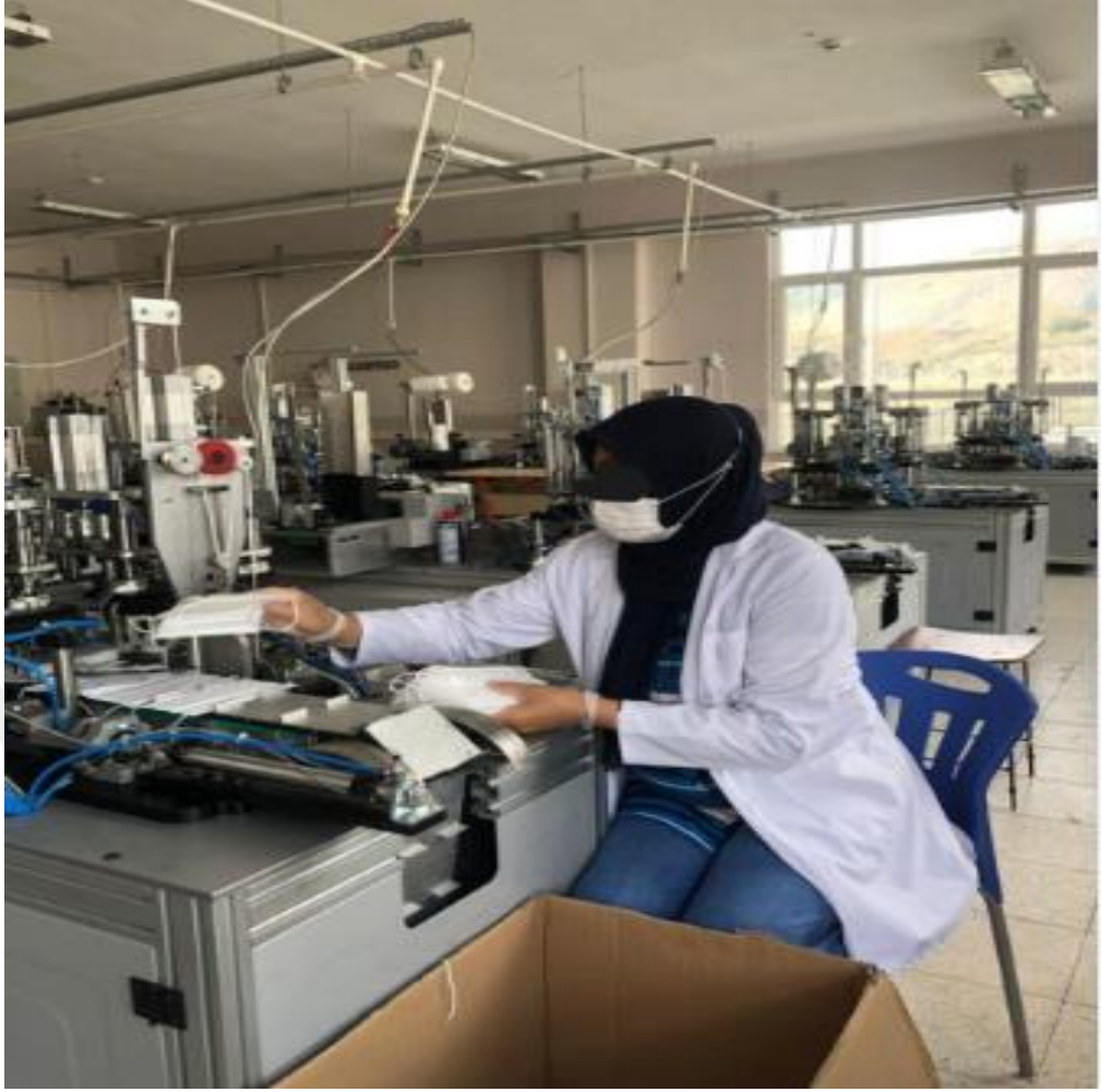
Şekil 5.35. Lastikleme makinesi toplama işleminde çalışanın yanlış oturma duruş görünümü
