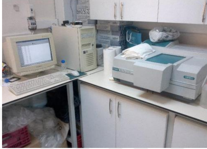
Şekil 3.3. Toplam fenol miktarı ve antioksidan aktivitesinin belirlenmesinde kullanılan spektrofotometre.
