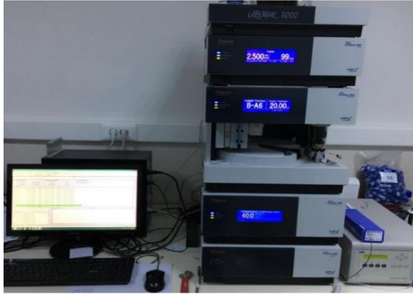
Şekil 3.6. Şeker bileşiminin belirlenmesinde HPLC cihazı.
