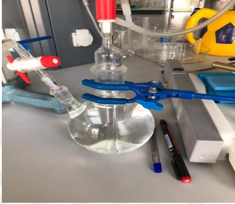
Şekil 4.1 Batch tipi reaktörde tavuk gübresi ve çöp sızıntı suyu ile biyogaz üretim sisteminde 2., 4. ve 24. saatlik su seviyesinde yükselme
