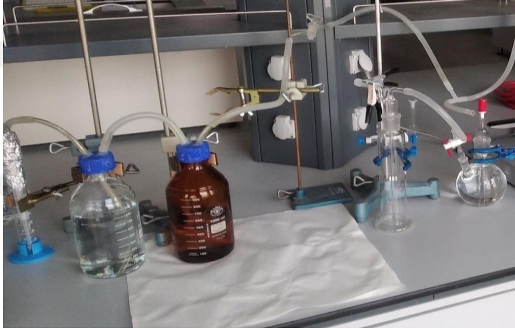
Şekil 3.2 Sıvıların yerdeğiřtirmesi prensibine baęlı biyogaz ölçüm düzeneęi
