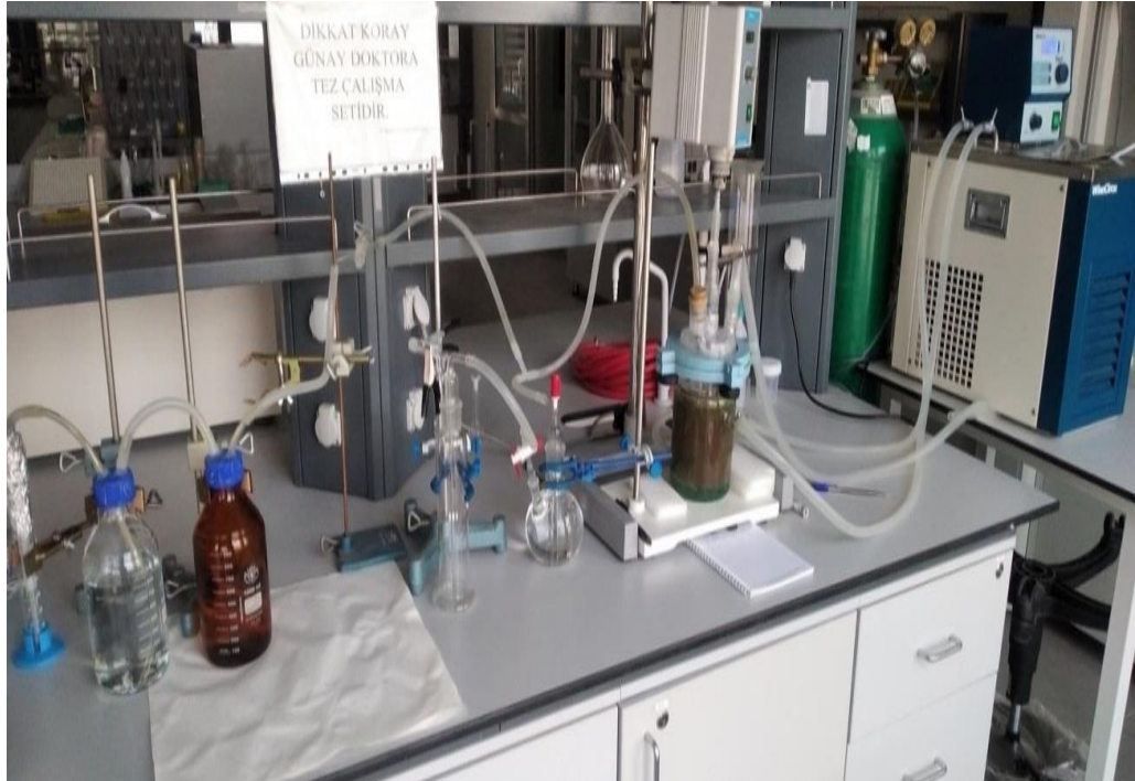
Şekil 3.1 Laboratuvar ölçeğinde batch tipi reaktörden oluşan biyogaz üretim sistemi
