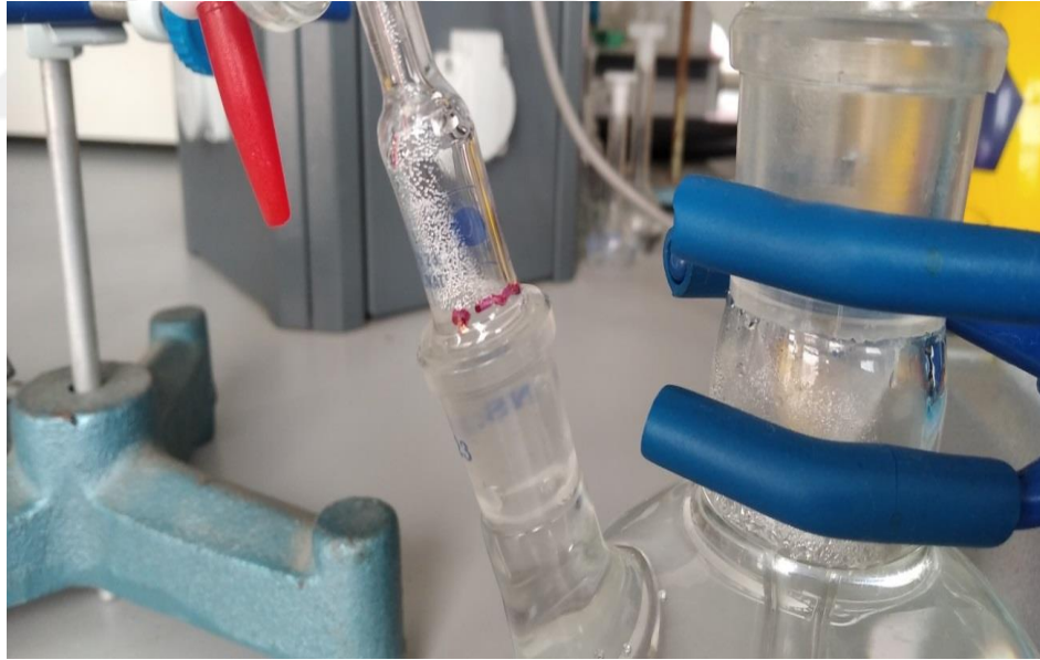
Şekil 4.3 Batch tipi reaktörde biyogaz üretiminde mikrodalga önışlemi uygulandığında gözlemlenen su seviyesi
