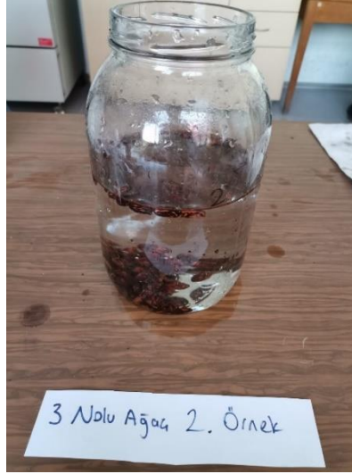
Şekil 3.14. Yüzdürme işlemi ile dolu ve boş iç fıstık ayrımı.
