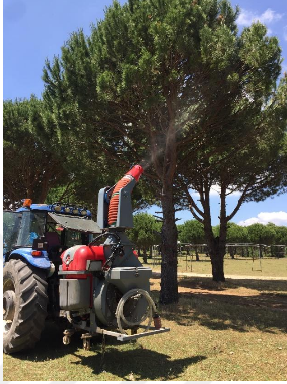
řekil 3.3. İlalama kullanılan Boa marka elektrostatik ilalama aleti.
