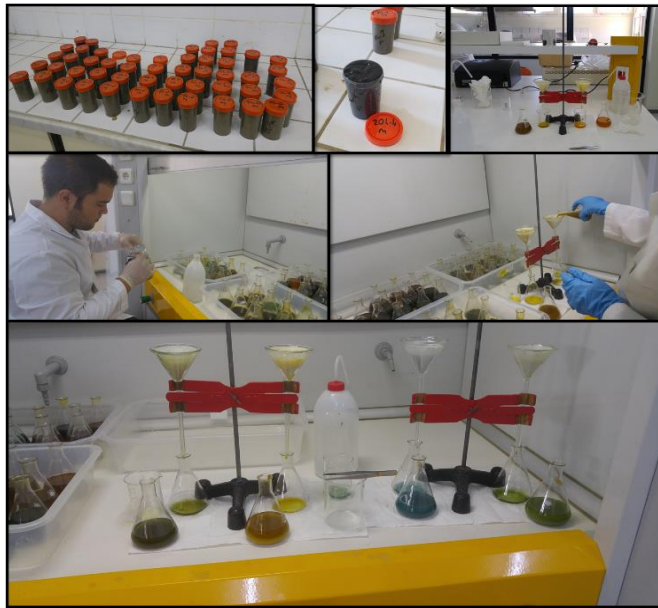
Şekil 2.3 Toplam organik karbonun spektrometre ile tayini deneyinden fotoğraflar.
