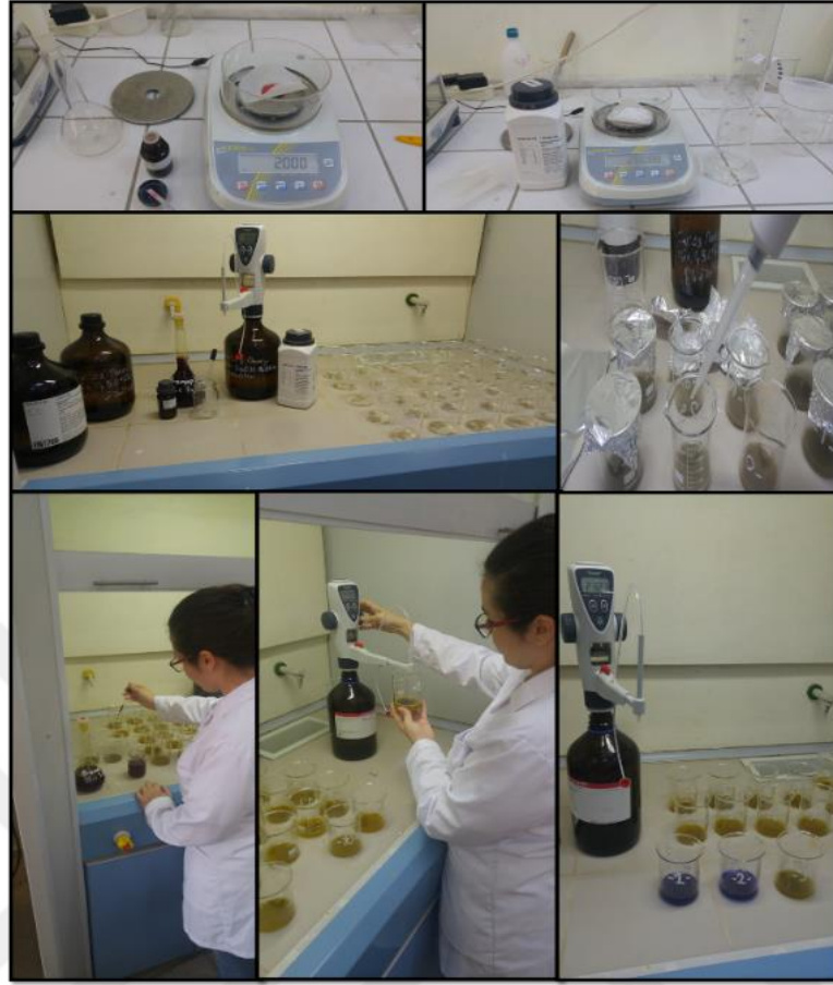
Şekil 2.4 Karbonat analizi deneyinden fotoğraflar; deneyde kullanılan kimyasal malzemeler, titrasyon donanımı ve örnekler.
