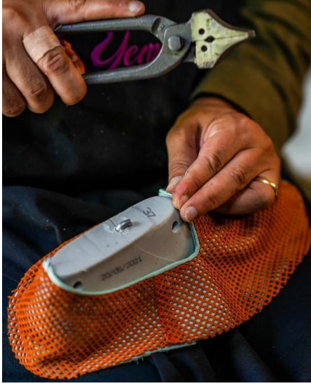
Resim 2.75. Saya Kalıba Çekilmesi
