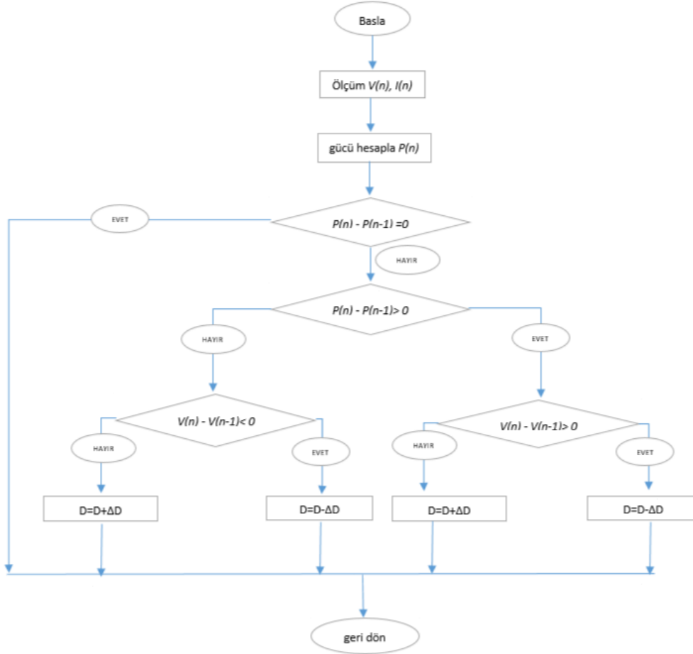
Şekil 3.3. Güneş paneli maksimum güç noktası takibi için değiştir ve izle algoritmasının blok diyagramı
