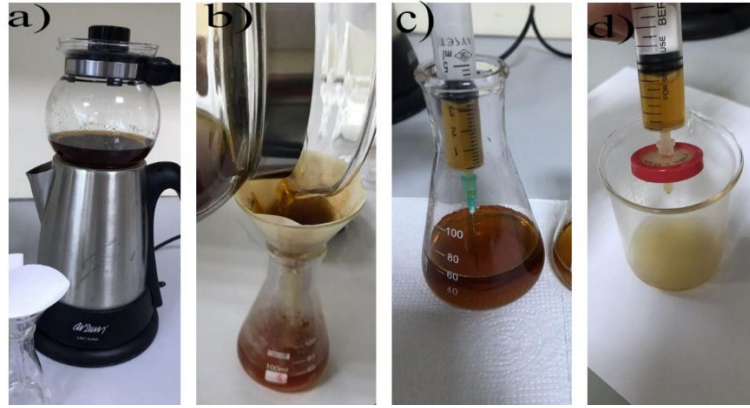
Şekil 10. (a) Kuru çay örneklerinin demleme işlemi (b) Çay solüsyonlarının süzgeçten geçirilme işlemi (c) Çay solüsyonlarının şiringa ile alınması işlemi (d) Çay solüsyonlarının 45µm filtreden geçirilme işlemi
