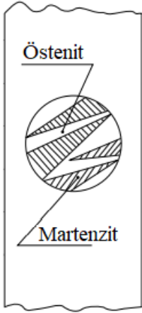
Şekil 3.4. Östenit ve Martenzit yapıların şematik gösterimi
