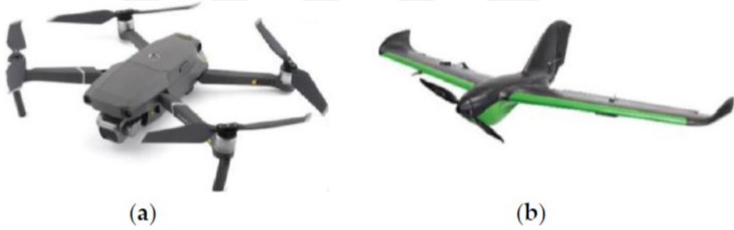
Şekil 1.2 Döner kanatlı (a) ve sabit kanatlı (b) insansız hava araçları [9]
