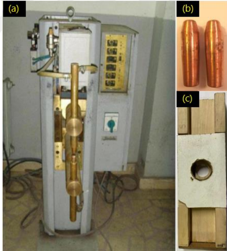
Şekil 3.2. Deney düzeneği (a) Nokta direnç kaynak makinesi, (b) Çeliklerin birleşiminde kullanılan elektrotlar, (c) Özel olarak hazırlanan ahşap fikstür [4]
