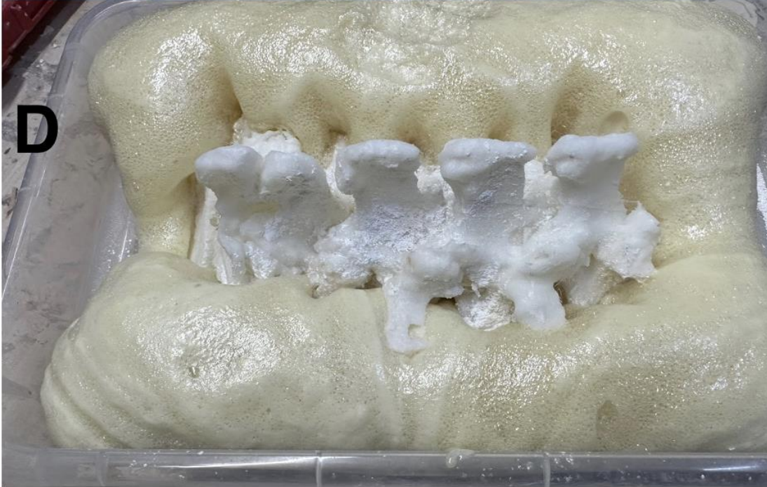
Resim 5 A) karışıma eklenen izosiyonat B) Karışıma eklenen poliöl C) Etkin maddelerin karıştırılmadan önceki görüntüleri D) Kimyasal tepkime sonrası oluşan destek maddesi
