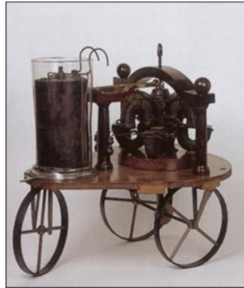
Şekil 2.4. Stratingh'in küçük elektrikli arabası (Guarnieri, 2011).
