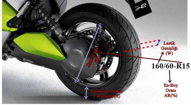
Şekil 4.4. BMW C Evolution arka lastik 160/60-R15 bilgileri (Zigwheels, 2022).
