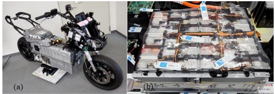
Şekil 3.5. (a) Aksesuarları sökülmüş BMW C Evo, (b) Pil modülü (Marklines, 2020).
