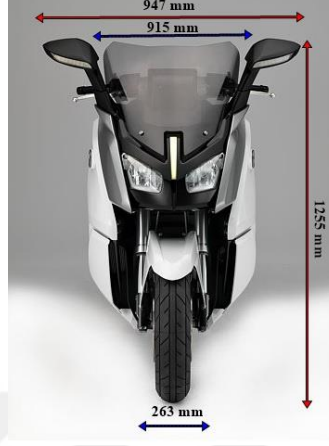
Şekil 4.6. BMW C Evolution ön yüzey ölçüleri (Ultimate Specs, 2022), Görsel : (Dexigner, 2022).
