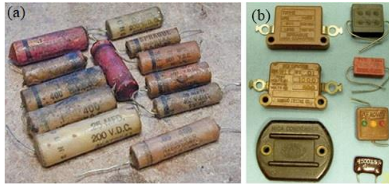
Şekil 2.30. (a) Eski radyolardan alınan mumlu kağıt ve folyo kapasitör örnekleri, (b) Eski mika kapasitörler (Ho et al., 2010).
