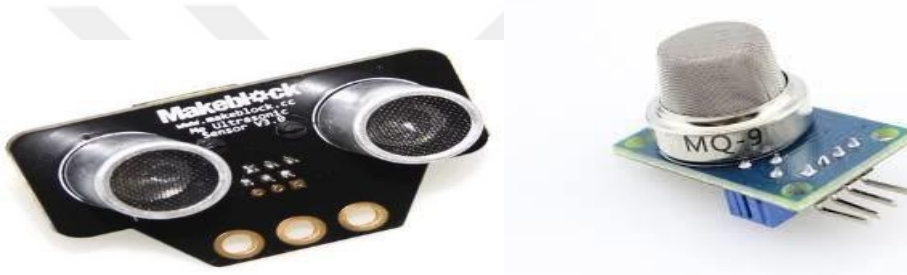
Şekil 2.6. Ultrasonik ve yarı iletken sensör
