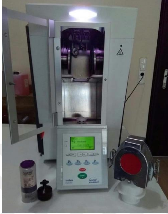
Şekil 3-8: Ivobase enjektör ünitesi
