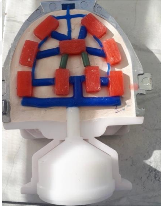
Şekil 3-7: Enjeksiyon kanallarının oluşturulması
