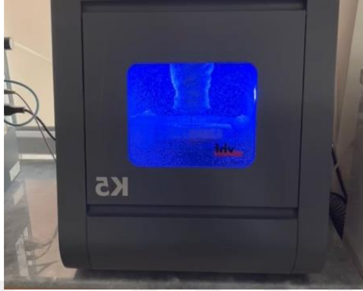
Şekil 3-12: VHF5 kazıma cihazı
