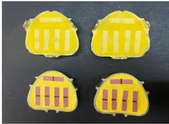
Şekil 3-21: Mum eliminasyonu sonrası mufladaki örnekler
