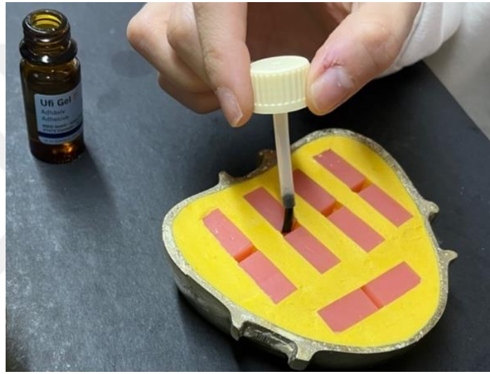
Şekil 3-24: Örneklerin bağlantı yüzeylerine adeziv uygulaması
