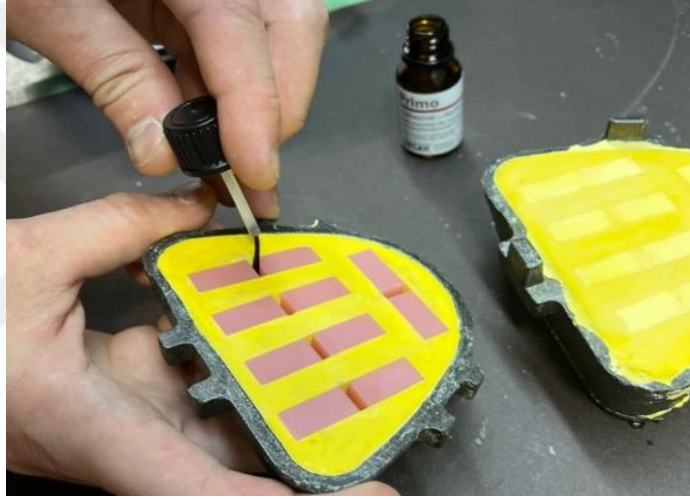
Şekil 3-22: Örneklerin bağlantı yüzeylerine primo adeziv uygulaması
