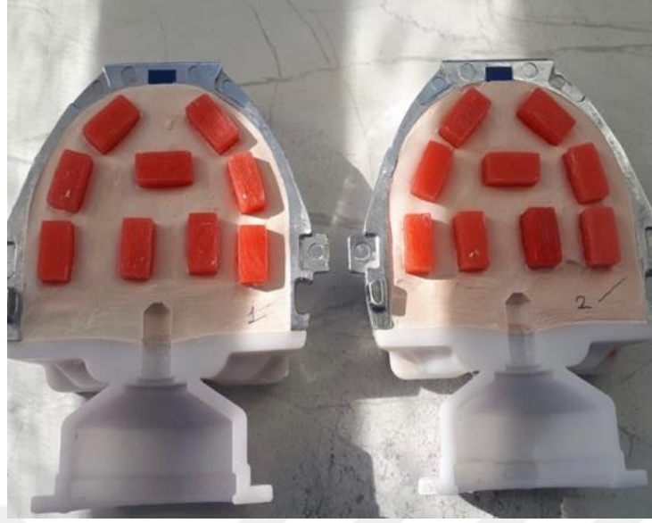
Şekil 3-6: Mum örneklerin muflaya yerleştirilmesi
