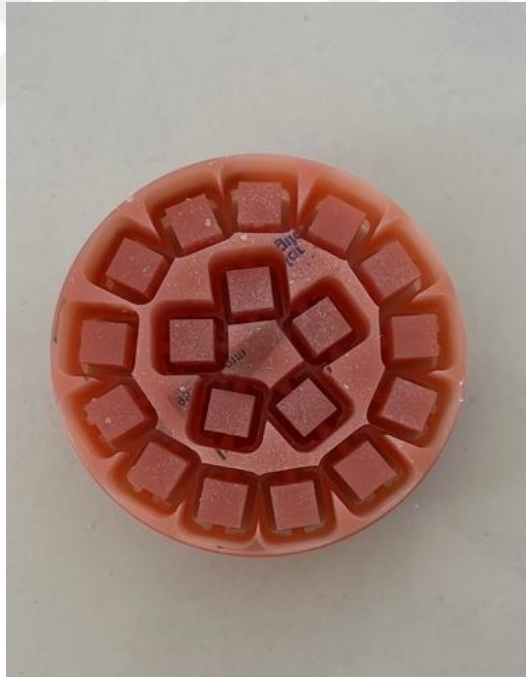
Şekil 3-13: Kazıma işlemi sonrası bloklar
