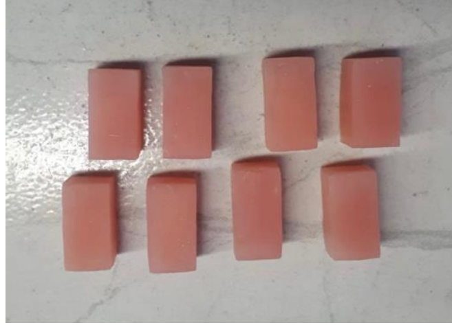
Şekil 3-10: Polisaj sonrası Ivobase High Impact örnekler
