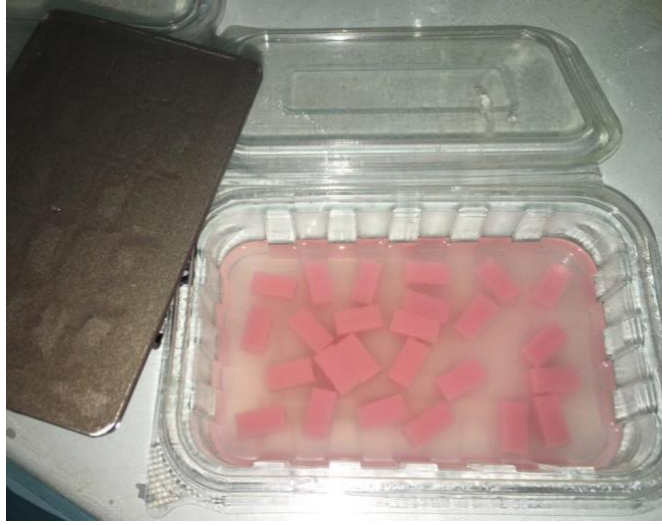
Şekil 3-16: Örneklerin izopropil alkol içerisinde bekletilmesi
