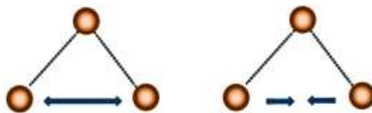
Şekil 4.4: Açık bükülme titreşimi
