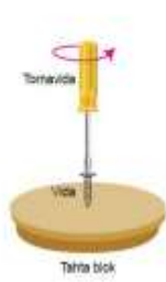
Şekil 1: Vida, tornavida ile döndürülerek tahta blokta ilerliyor.
