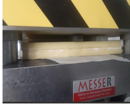
b) Kalıpla pres arası sıkıştırma levhası
