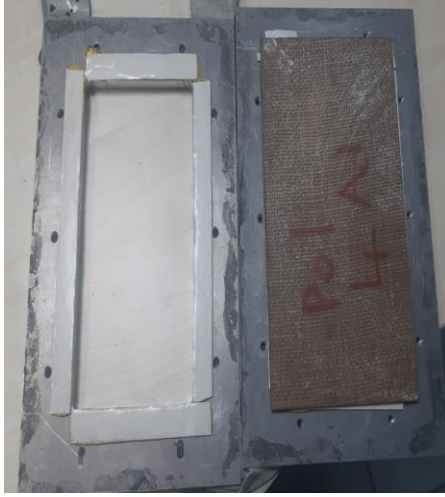
a) Tekstil atığı takviyeli kompozit plakanın akustik ölçüm kalıbına yerleştirilmesi
