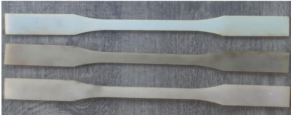
b) Çekme testi için üretilen örnekler
