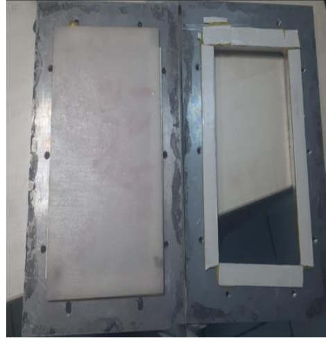
b) Cam elyaf takviyeli kompozit plakanın akustik ölçüm kalıbına yerleştirilmesi
