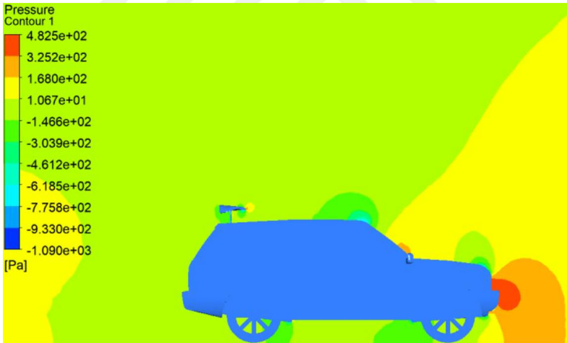
Şekil 4.5b. MODEL1 üzerindeki basınç dağılımı (yan görünüş)
