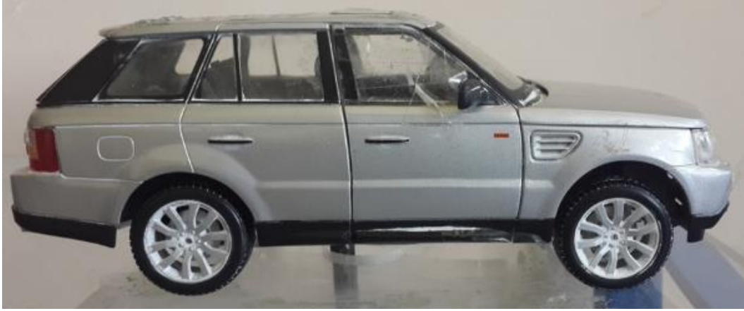
Şekil 3.1b. 1/32 ölçekli SUV test model aracı
