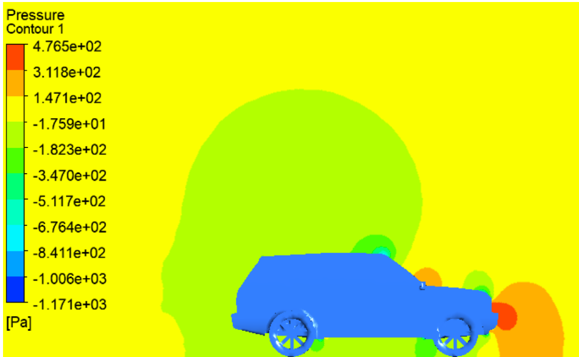
Şekil 4.5a. TM üzerindeki basınç dağılımı (yan görünüş)
