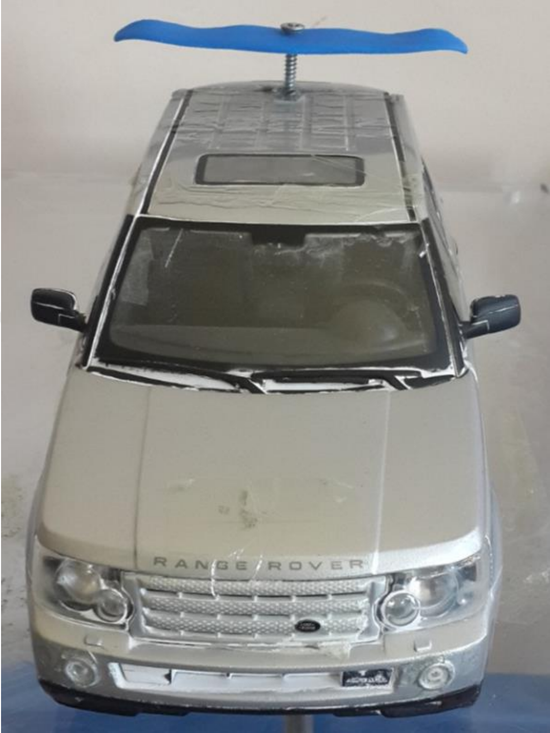
Şekil 3.5. Spoilerin SUV araç modeli üzerindeki konumu
