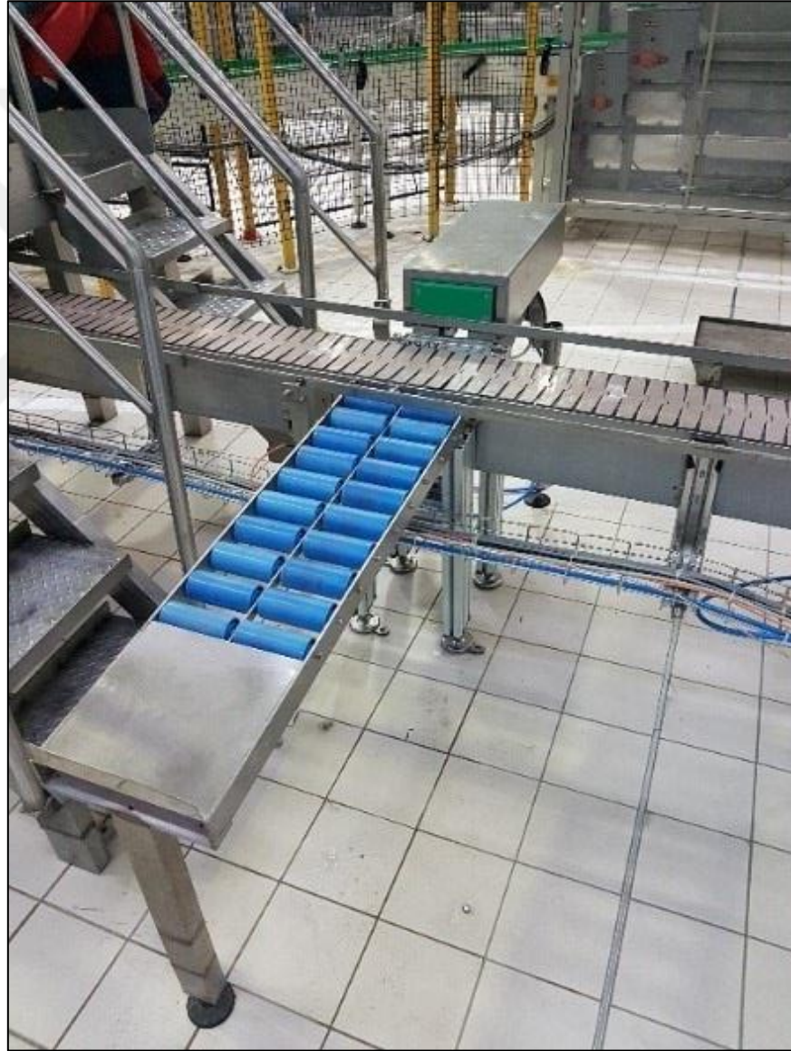
Şekil 4.6. Yoğurt dolum makinesi hattına montajlanmış ayırıcı pistonu ve konveyörü
