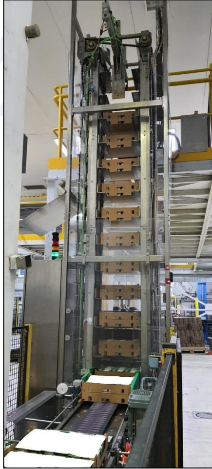
Şekil 3.18. Yoğurt dolum makinesi hattı elevatör
