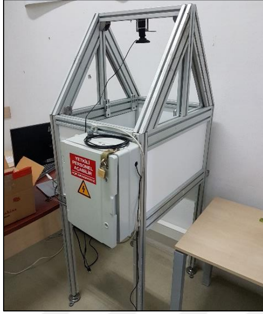
Şekil 4.15. Kamera montajlanmış kabin
