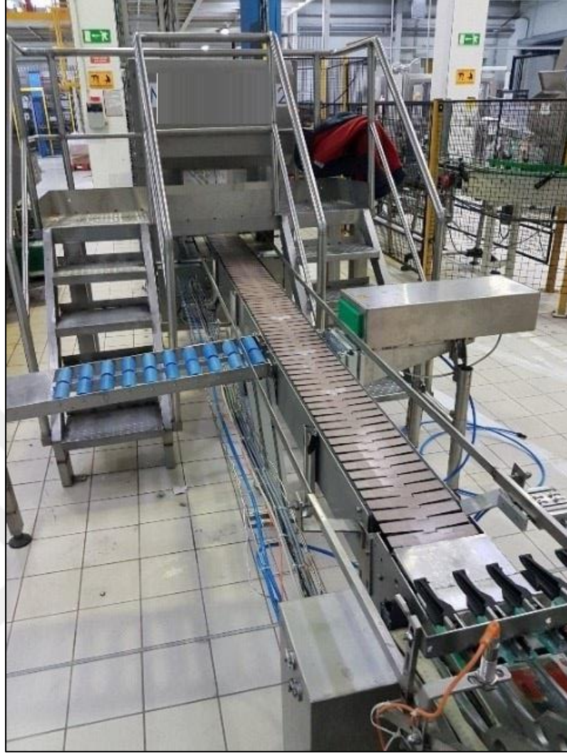
Şekil 4.7. Yoğurt dolum makinesi hattına montajlanmış ayırıcı pistonu ve konveyörü
