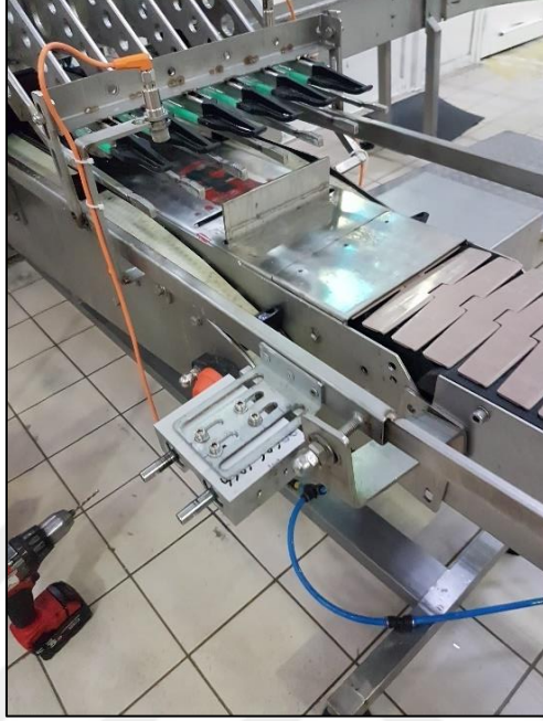
Şekil 4.4. Yoğurt dolum makinesi hattına montajlanmış koli tutucu piston
