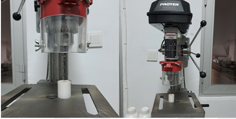
Şekil 3.8: Sütünlü matkapta örneklere yuvalar açılması
